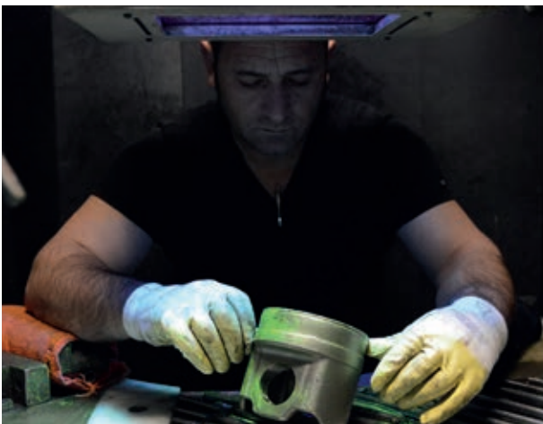
Bild 11.7: Blick in eine Fluxkabine
