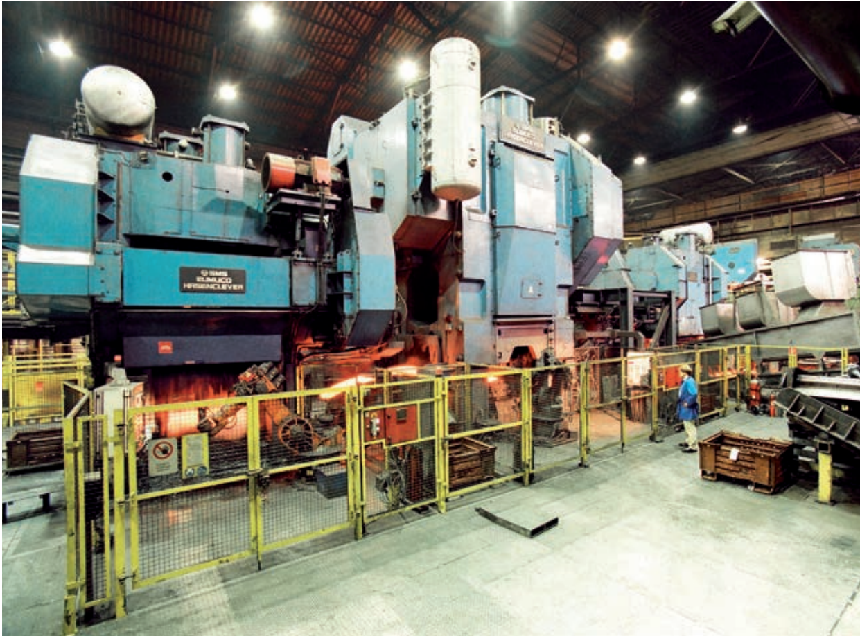
Bild 1.5: Blick in eine Produktionshalle mit einer durch Roboter verketteten automatisierten Schmiedeanlage
