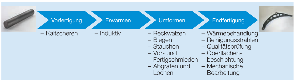
Bild 7.2: Prozesskette Gesenkschmieden am Beispiel der Fertigung eines Querlenkers
