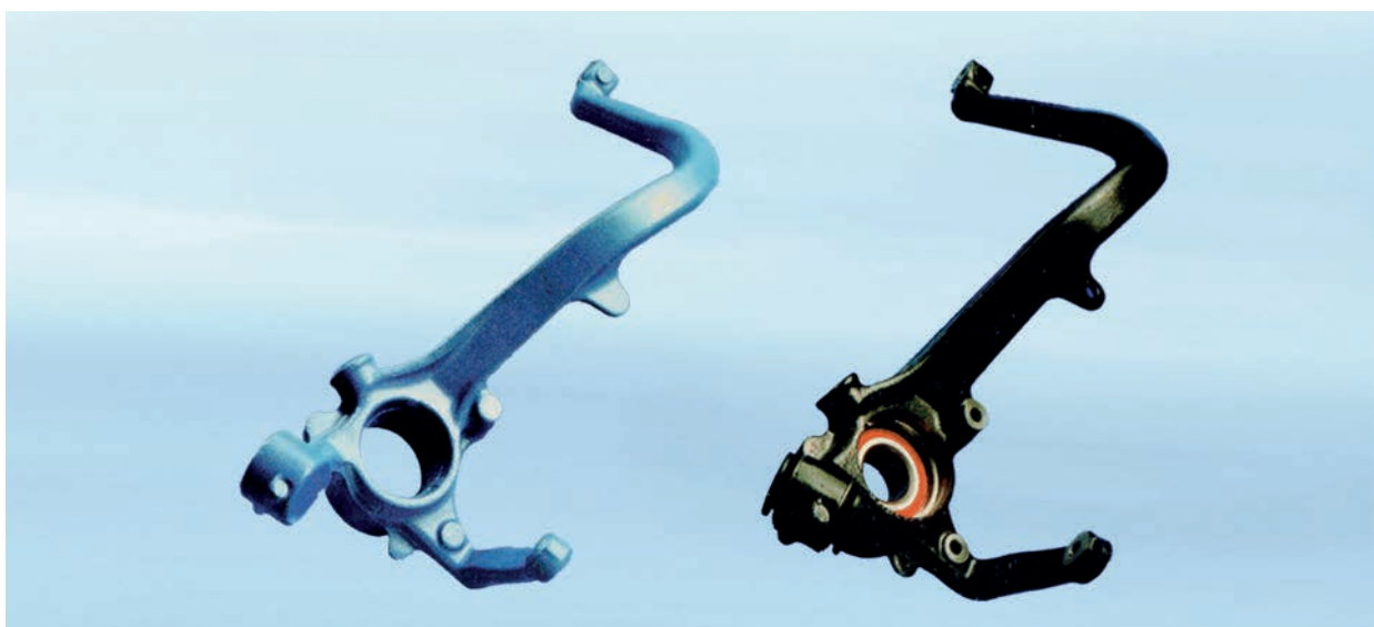
Bild 10.2: Rohteil und Fertigteil am Beispiel eines gesenkgeschmiedeten Pkw-Schwenklagers
